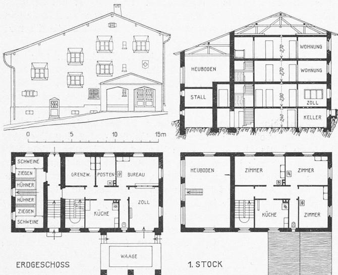
Abb. 1. Grundriss, Schnitt und Strassenfront des Zollhauses Splügen. — 1 : 400.
