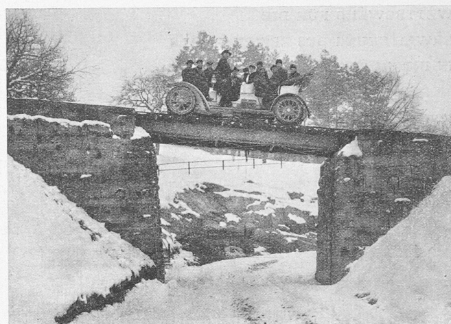
Abb. 3. Das Saurer 50 PS Personen-Automobil für Fahrten auf Schienen auf der Bergfahrt Rorschach-Heiden im Februar 1908.
