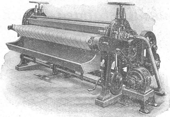
Neue Muldenmangel CD mit direktem Motorantrieb, doppelseitiger Wrasenabsaugung, automatischer Wäscheinführung, Walzenhebung und Abstreifvorrichtung.
