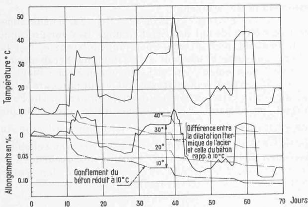
Fig. 1. Déformation linéaire d'une poutre de 2 m de longueur en béton à 400 kg de ciment par m<sup>3</sup> immergée dans l'eau, en fonction de la température et du temps. Les appareils de mesure (comparateurs Stoppani) étant fixés à des tiges d'acier de même longueur que la poutre, on observe la différence entre la dilatation thermique de l'acier et celle du béton. On a déterminé  $\alpha_{\text{Béton}} = 0,0000119 - 0,0000037 = 0,0000082 = -2/3 \alpha_{\text{Fer}}$ .
