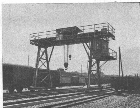
Fahrbarer Bockkran mit zwei Hubwerken
