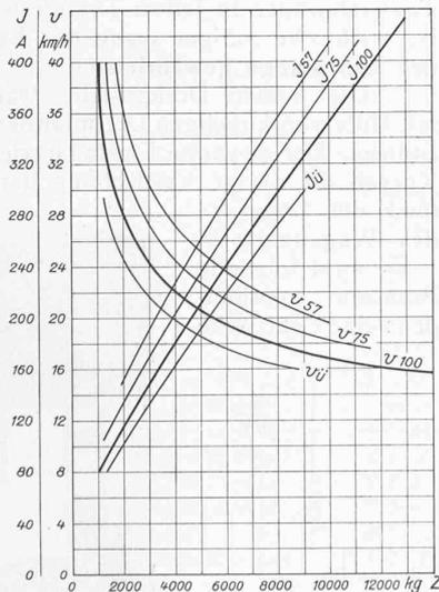
Abb. 4. Charakteristische Kurven des Fahrzeuges.
