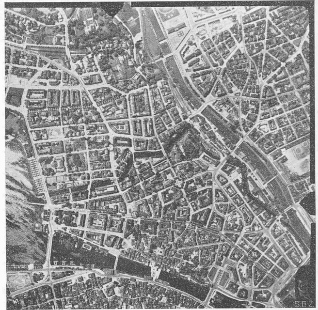
Abb. 35. Senkrechtaufnahme von Zürich aus 2800 m über Boden (3200 m ü. M.) mit Wild'scher Fliegerkammer, Brennweite 165 mm, Plattenformat 13 \times 13 cm. (Cliché in Naturgrösse, links und unten rd. 3,5 cm breit Bildrand abgeschnitten.)
