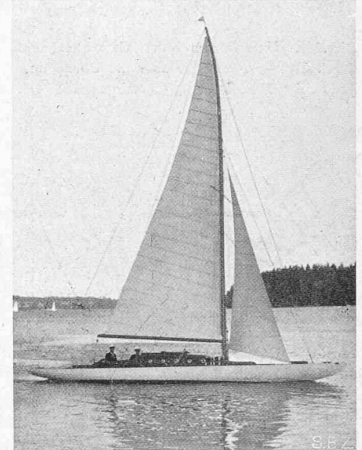
Abb. 36 und 37. 40 m 2 -Schärenkreuzer (Regattaboot) aus Eisenbeton mit Sika-Zusatz; Wandstärke 10 mm. — Ing. Yberg, Ramvik, Schweden. — Gewicht 1500 kg, d. h. nur 300 bis 400 kg mehr als Holzbau. [Beschreibung folgt 1933.]
