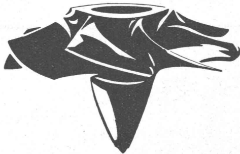
Lauftrad von 5 m Durchmesser und 26 t Gewicht, zu einer modernen Propeller-Turbine von 15000 PS Leistung.
