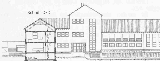
Abb. 4. Schnitt C-C, Eingang, gedeckte Spielterrasse. — 1 : 600.
