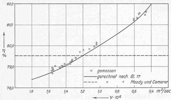
Abb. 1. Totaler Wirkungsgrad in Funktion der kinematischen Zähigkeit.
