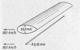
Abb. 1. Zwei (unendlich breite) theoretische Flugzeugmodelle von gleichem Luftwiderstand.
