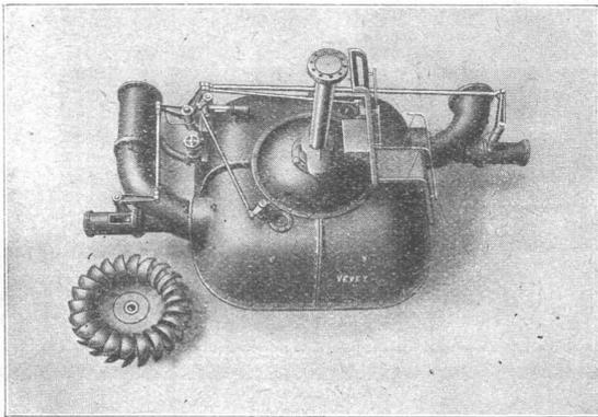
Eine der drei Pelton-Turbinen mit vertikaler Achse und zwei Düsen, des Kraftwerkes Sembrancher (Wallis).
