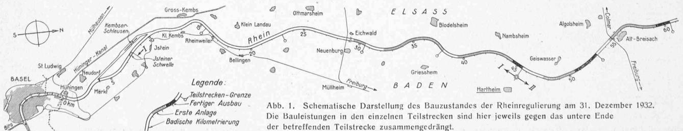
Abb. 1. Schematische Darstellung des Bauzustandes der Rheinregulierung am 31. Dezember 1932. Die Bauleistungen in den einzelnen Teilstrecken sind hier jeweils gegen das untere Ende der betreffenden Teilstrecke zusammengedrängt.
