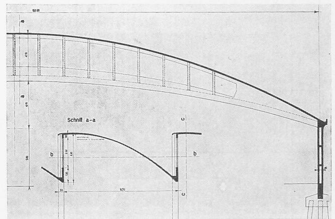
Einzelheiten des Schalengewölbes von Entwurf Nr. 27. — Masstab 1 : 300.
