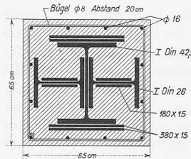
Abb. 16. Stützen-Querschnitt. Masstab 1 : 25.
