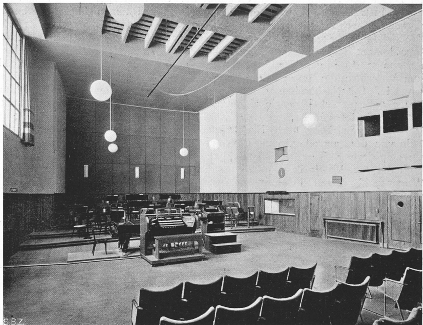
Abb. 9. Grosses Studio, rechts Kontrollfenster und Besucherloge. Verstellbare Deckenöffnungen.
