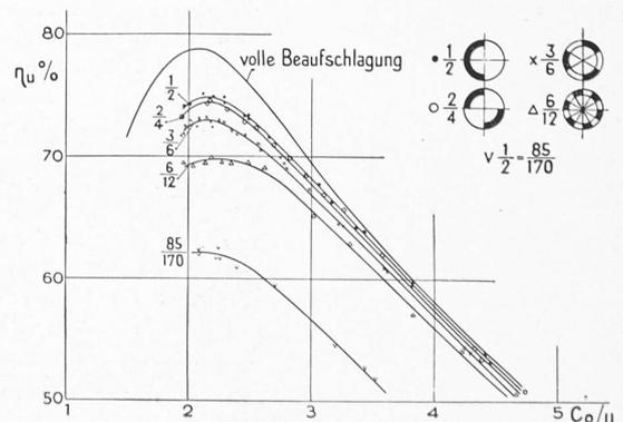
Abb. 17. Resultat einer Wirkungsgrad-Bestimmung bei verschiedenartiger halber Beaufschlagung.
