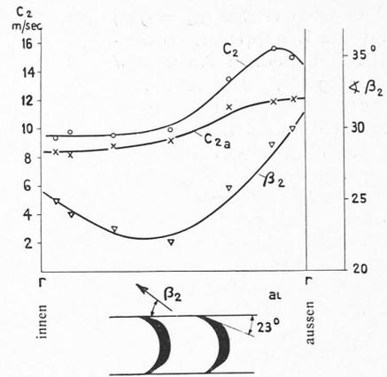
Abb. 18. Messung von Austritts-Geschwindigkeit und -Richtung am rotierenden Laufrad.
