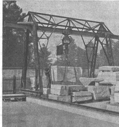
Bockkran für Steintransport
