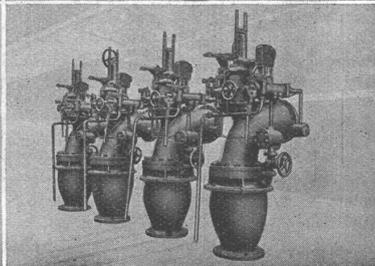
Oben: Keilschieber 2500 mm Nennweite, 7 at Druck, für ein Kraftwerk in Spanien. — Unten: Drehschieber 1500 mm Nennweite, 15 at Druck, für ein automatisches Kraftwerk in Deutschland.
