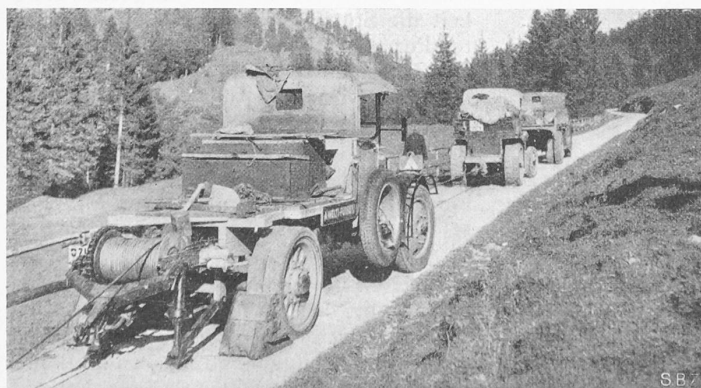
Abb. 16. Saurer-Traktor mit Winde für 15 t max. (kombinierte) Zugkraft.
