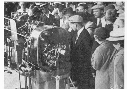
Abb. 25. Schrauben-Automat im Betrieb.
