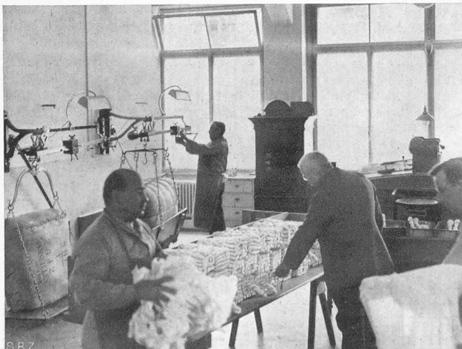
Abb. 5. Feststellung des Nettogewichtes (Erdgeschoss).
