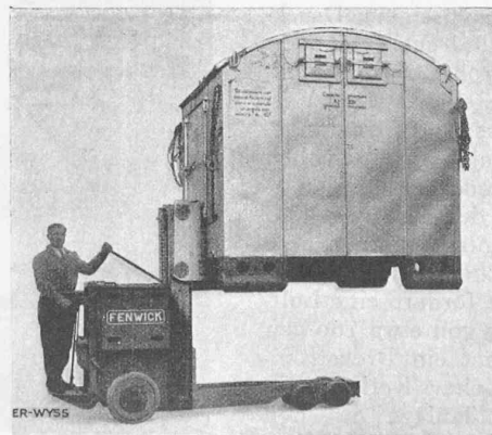
Abb. 2. SICON-Behälter auf elektr. Hubtraktor.
