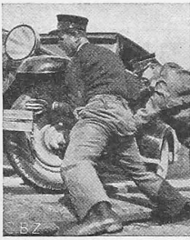
Abb. 1. Heutiger Seitenverlad der Autos auf die Bahn. — Die oft nötige kräftige Nachhilfe von Hand ist der Karosserie wenig förderlich und darum der Bahntransport beim Fahrer unbeliebt. — Im Gegensatz hierzu würde die «Autofähre» geradezu anziehend wirken.
