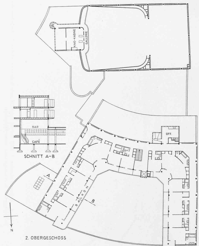
Abb. 1 und 2. Grundrisse und Schnitt 1:600 des Grand Hotel Gooi in Hilversum. — Arch. † J. DUIKER.
