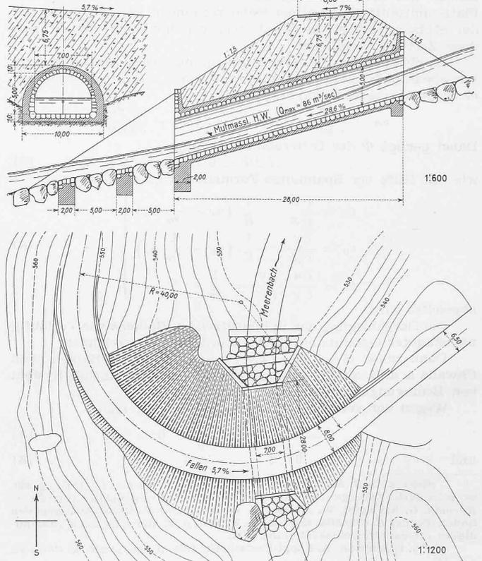
Abb. 3. Durchlass von 30 m<sup>2</sup> durch den Damm im Meerenbachtobel hinter Mühlehorn (Deponie des Ausbruchs aus dem Fuchsfallenhorn-Tunnel).
