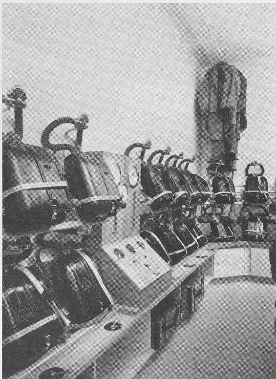
Abb. 11. Sauerstoffgeräte und Dräger-Grossdichtprüfanlage.
