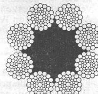
unsere PATENTIERTEN „OX-LAY-IDEAL-KONSTRUKTIONEN“ (+ Patent und D. R. P.)
