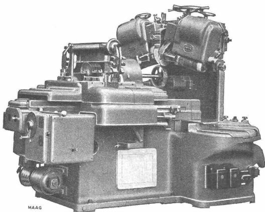
MAAG - ZAHNRADSCHLEIFMASCHINE
