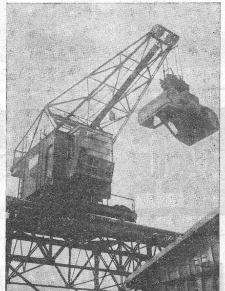
Verwendung v. Draht- seilen in Greifer- Kranen.
