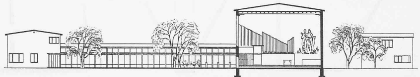
Pfarrhaus, Saaltrakt, Querschnitt Kirchenraum und Sigristenhaus. — Masstab 1 : 600.
