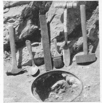
Abb. 17. Probeloch und zugehörige Werkzeuge
