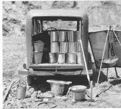
Abb. 16. Materialprüfungswagen mit Geräten
