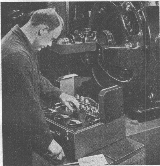
Z-Messkoffer für Wechselstrom-Leistungsmessungen bei der Ueberprüfung einer Maschine
