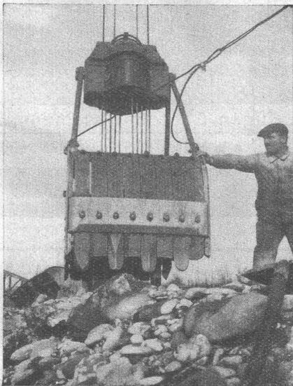
Verwendung von Stahlseilen in Greifbaggern
