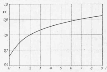
Abb. 3. Theoretische minimale Vortriebsarbeit für verschiedene Exponenten der Geschwindigkeitsverteilung
