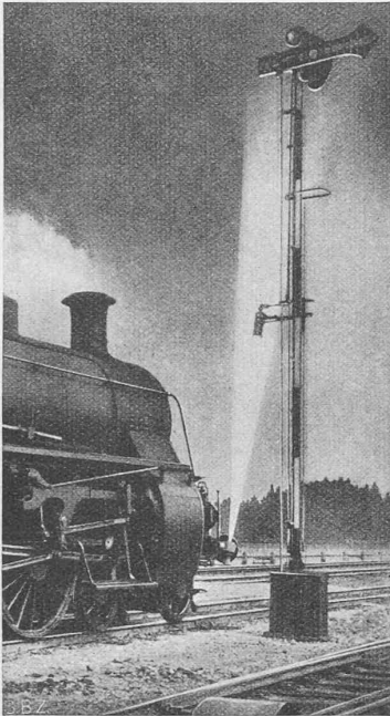
Abb. 1. Anordnung von Scheinwerfer (auf der Lokomotive) und Tripelspiegel (am Signal)
