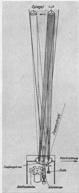
Abb. 2. Wirkungsweise des Tripelspiegels zur optischen Signalübermittlung
