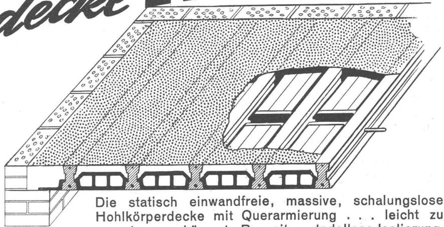
Die statisch einwandfreie, massive, schalungslose Hohlkörperdecke mit Querarmierung . . . leicht zu versetzen . . . kürzeste Bauzeit . . . tadellose Isolierung.
