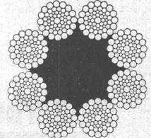
unsere PATENTIERTEN „OX-LAY-IDEAL-KONSTRUKTIONEN“ (+ Patent und D. R. P.)
