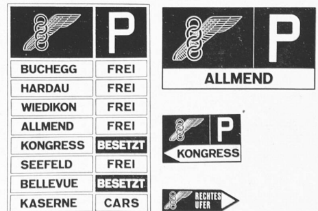
Abb. 56. Links: Parkorientierungstafel. Rechts: Oben Parkplatztafel, Mitte Park-Wegweiser, Unten gewöhnlicher Wegweiser. LA-Signet weiss auf rotem, P auf blauem Grund. — Masstab 1 : 50
