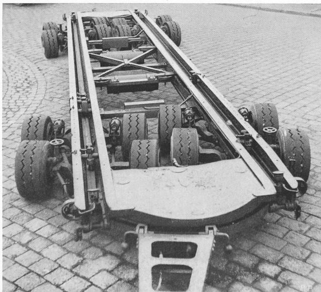
Abb. 4. Der SBB-Rollschemel in einer Kurve
