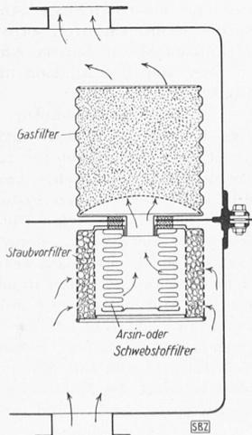
Abb. 6 (rechts). Schematischer Schnitt durch ein LUWA-Filterelement
