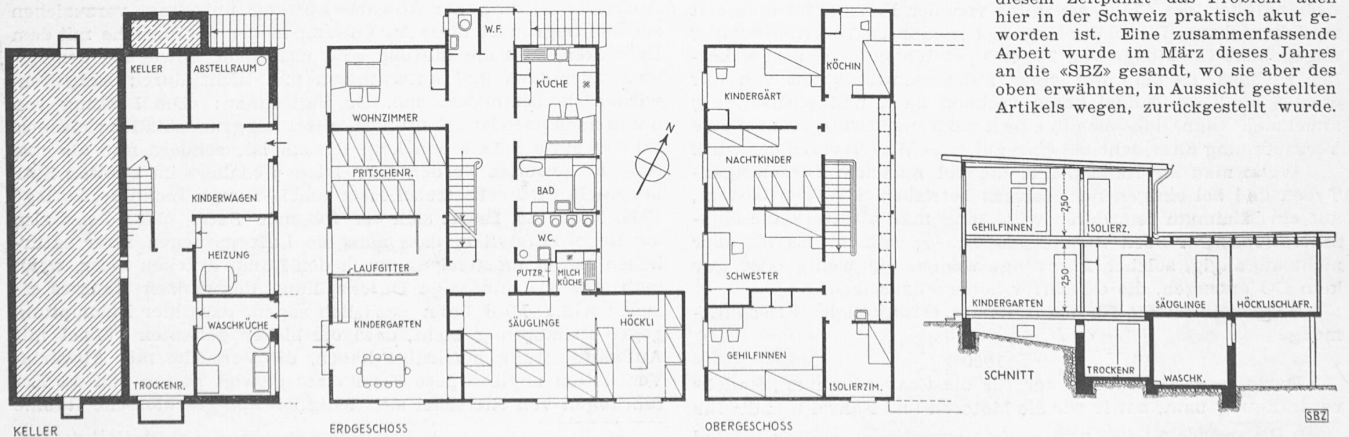
Abb. 1. Grundrisse und Schnitt der Kinderkrippe von Lindt & Sprüngli in Kilchberg bei Zürich. — Masstab 1 : 250
