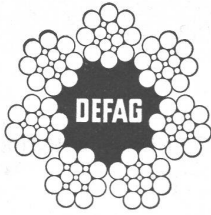
drallarme und spannungs- freie Normal-Litzen- Konstruktion
