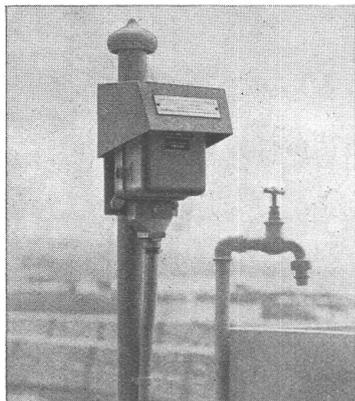
No. JA-2612. Fig. 1. Im Freien aufgestelltes Wärmeverlustmessgerät f. d. selbsttätige Heizungsregulierung im Gurkenhaus der LA (Landis & Gyr).
