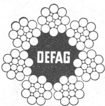
drallarme und spannungs-freie Normal-Litzen-Konstruktion
