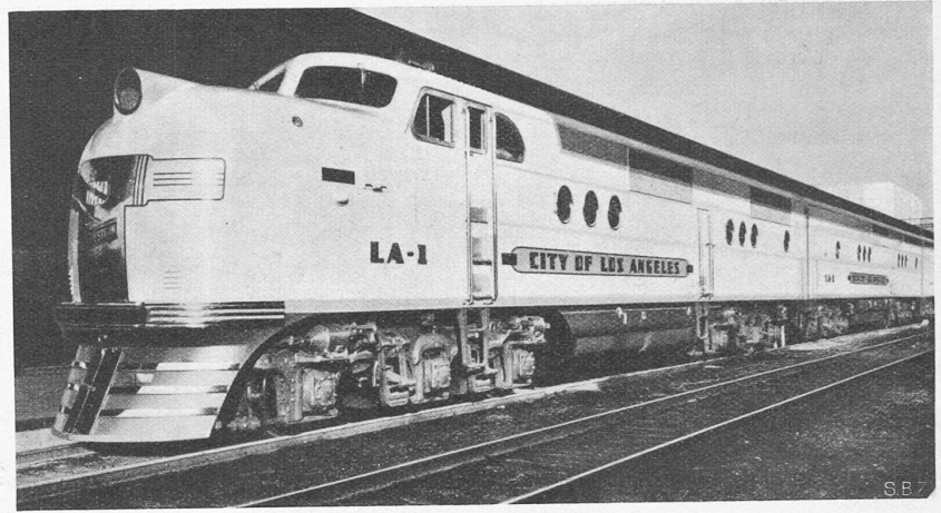
5400 PS-Diesel-elektrische Lokomotive der Union Pacific Railroad
