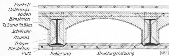
Abb. 39. Anordnung der Sulzer-Deckenheizung in den Obergeschossen
