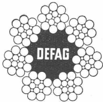
drallarme und spannungs- freie Normal-Litzen- Konstruktion
