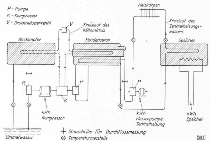
Abb. 16. Aufbau-Schema der Escher Wyss-Wärmepumpanlage im Zürcher Rathaus
