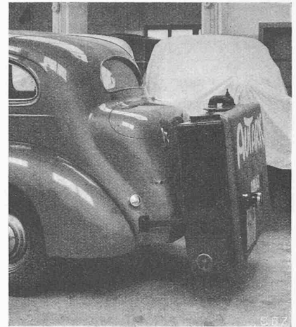
Abb. 8. Holzkohlengas-Generator AUTARK Anbau hinten an einen Personenwagen
