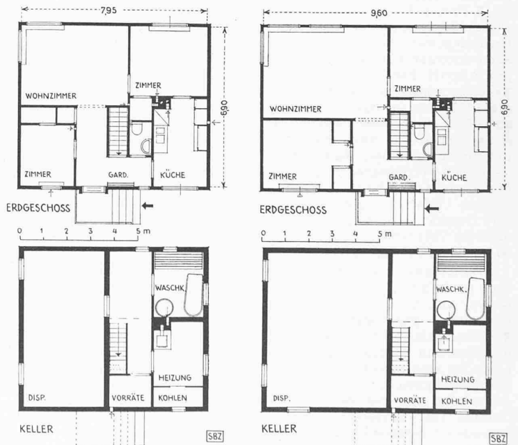
Abb. 1. Typ V — Schwedische Kleinhaustypen 1: 200 — Abb. 2. Typ VI
